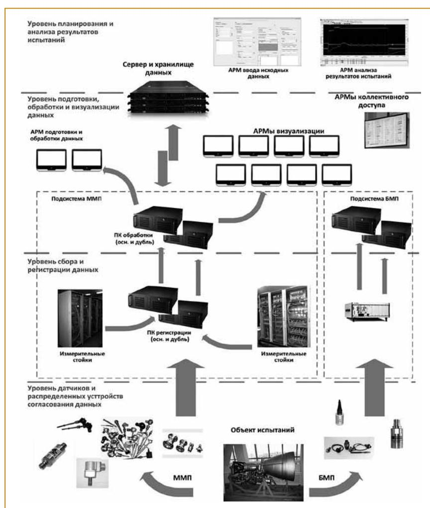
Рис. 4. Общая структура комплексной системы автоматизации стенда огневых испытаний ЖРД в ФКП «НИЦ РКП»
