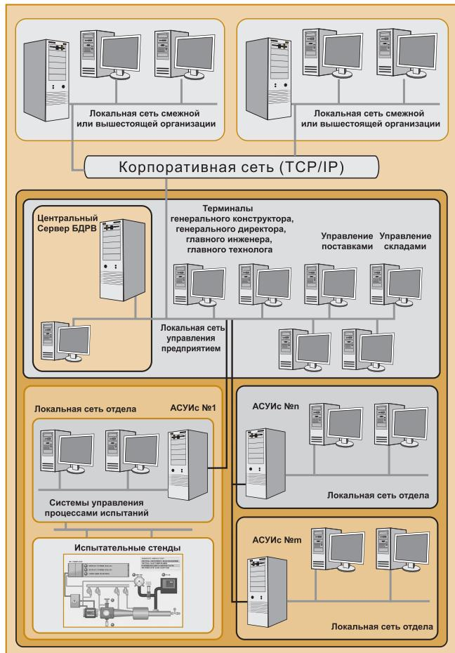
Рис. 2. Иерархическая многоуровневая интегрированная территориально-распределенная система автоматизации
