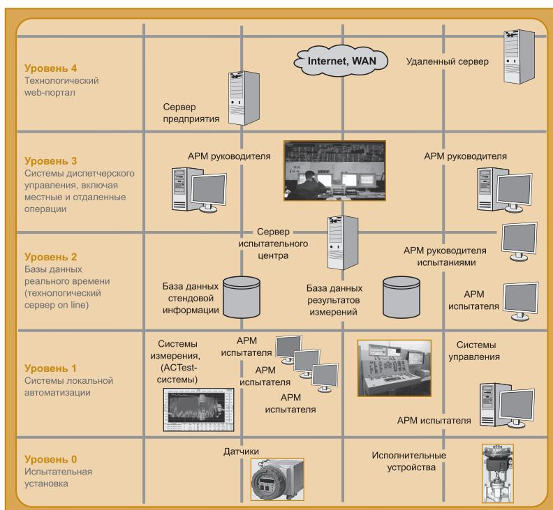
Рис. 1. Вертикальная и горизонтальная декомпозиция общей задачи: любой модуль или любой уровень – это решение частной задачи или построение локальной системы. Все вместе – комплексная автоматизация испытательной базы предприятия.
