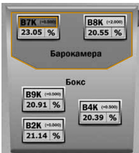
Рис. 3. Помещение после срабатывания порогового реле
