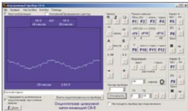
Рис. 4. “Виртуальный прибор” осциллограф С9-8 – интерфейс программы управления реальным прибором
