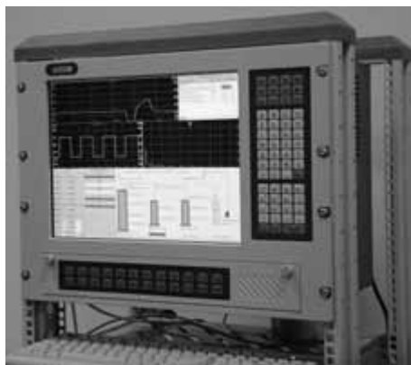
Рис. 8. Система автоматизации стендовых испытаний на базе комплекса АСTest
