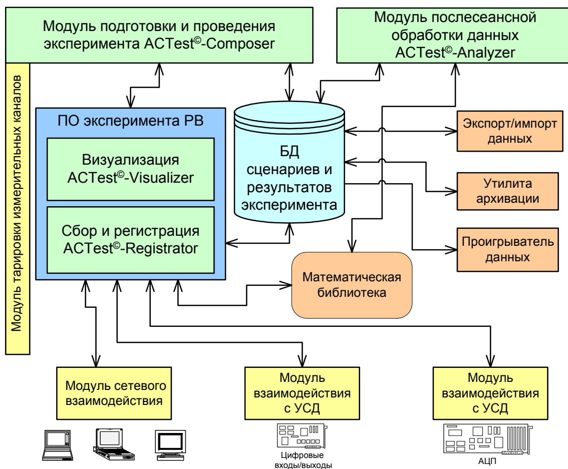
Рисунок 1. Структура программного обеспечения комплекса АСТest ®
