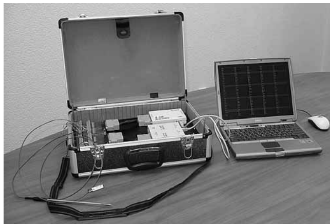
Рис. 6. Мобильная измерительная система на базе ноутбука и переносного блока согласования с объектом
