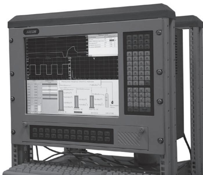
Рис. 6. Система автоматизации стендовых испытаний на базе комплекса АСТест
