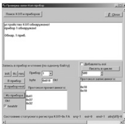
Рис. 5. Пересылка в выбранный прибор информации и протоколы переданных в прибор и принятые из прибора байт
