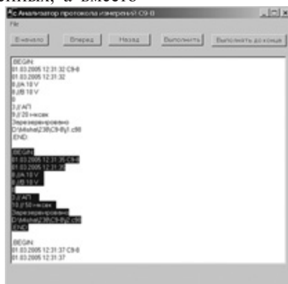
Рис. 2. Анализатор протокола С9-8. Нажатие кнопки "Выполнить" вызывает повторное выполнение выделенного измерения с автоматической настройкой параметров осциллографа и записью результатов в указанный файл. Кнопки "Вперед", "Назад" позволяют смещаться по протоколу без повторного измерения. Одновременно с выполняемыми измерениями может автоматически формироваться новый протокол
